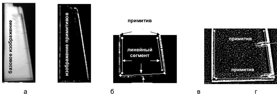
Рис. 36. Объектное выравнивание по базовому изображению (показана процедура нахождения несоответствий на цифровом рентгеновском снимке лопатки ГТД)
