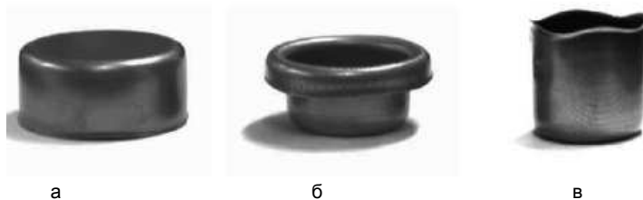
Рис. 11. Вытяжка оболочки из сплава АА 3104: а - первый переход; б - второй переход при длине хода пуансона 20 мм; в - изделие в конце второго перехода
